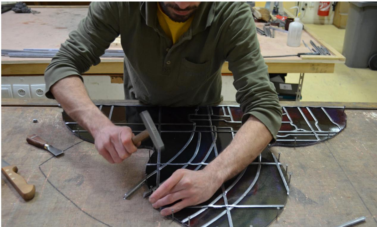
Assemblage, mise en plomb traditionnelle, soudure et contre-soudure des plombs.
