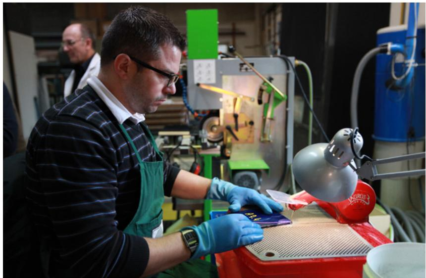
Atelier de travail "à froid" pour la découpe des formes au fil diamanté de 2 mm d'épaisseur.
