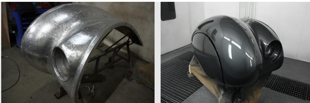
Elément de carrosserie avant et après la peinture et les finitions – Atelier Automobiles Anciennes Dominique Tessier
