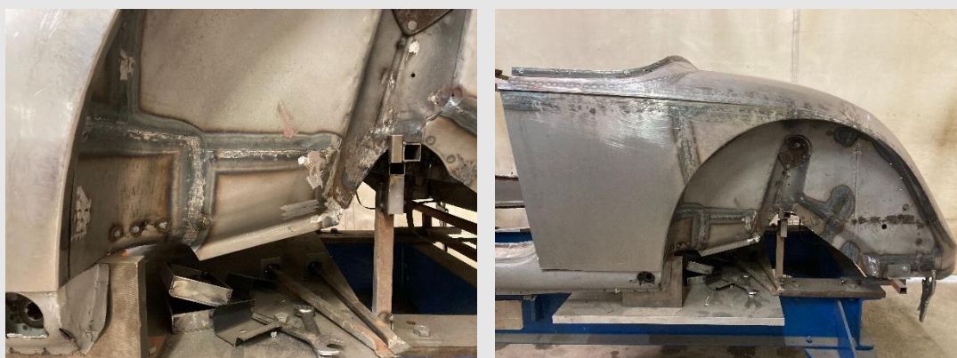
Vue d'une greffe (gros plan et plan large) – Atelier Automobiles Anciennes Dominique Tessier
