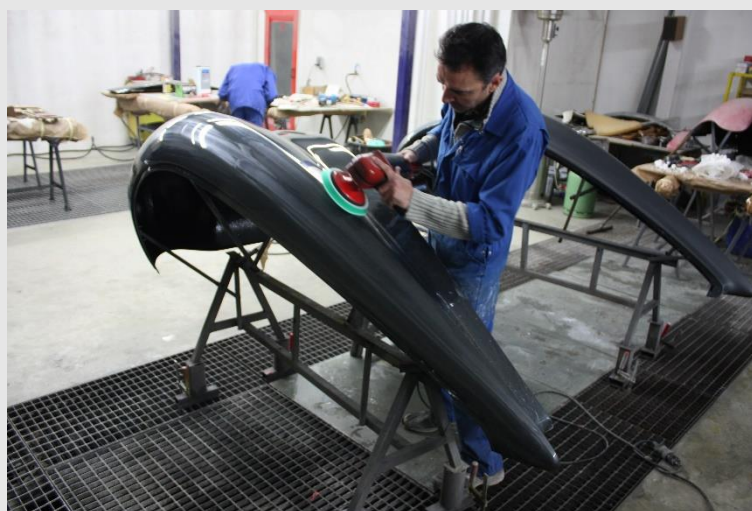
Utilisation d'une polisseuse – Atelier Automobiles Anciennes Dominique Tessier
