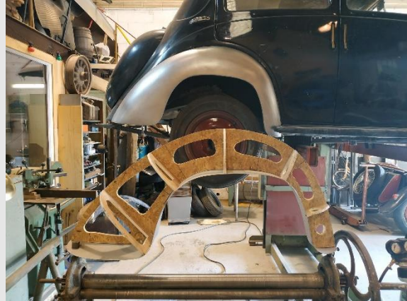
Maquette à sections en métal et maquette à sections en bois avec la pièce finie en arrière-plan Atelier Paul Chevallier
