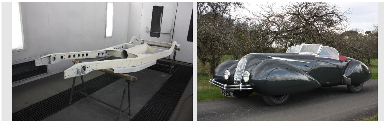
Exemple de reconstruction Roadster Delahaye 135 1948 Figoni (à gauche : le châssis Delahaye 135 – à droite : la reconstruction achevée d'après une création du carrossier Figoni) – Atelier Automobiles Anciennes Dominique Tessier
